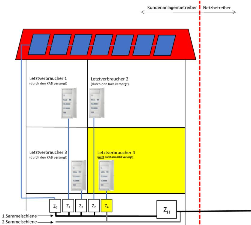
Erfolgt die Belieferung eines Letztverbraucher nicht mehr durch den KAB, wird der entsprechende Zähler auf die 2. Sammelschiene umgehängt. Die mit dem Lieferanten des Letztverbraucher 4 abgerechnete Energie entspricht dem Messergebnis des Zählers  $Z_4$ . Die mit dem KAB abgerechnete Energie entspricht dem Messergebnis des Zählers  $Z_H$ .
