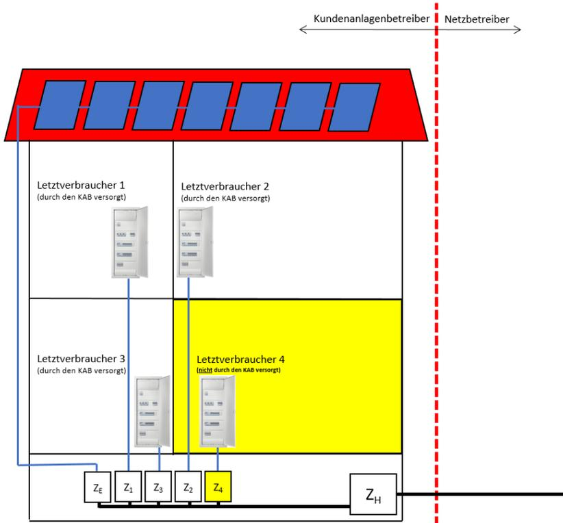
Letztverbraucher 4 wird nicht durch den KAB versorgt. Die mit dem Lieferanten des Letztverbraucher 4 abgerechnete Energie entspricht dem Messergebnis des Zählers  $Z_4$ . Die mit dem KAB abgerechnete Energie entspricht dem Messergebnis des Zählers  $Z_H$  abzüglich der Menge  $Z_4$ .
